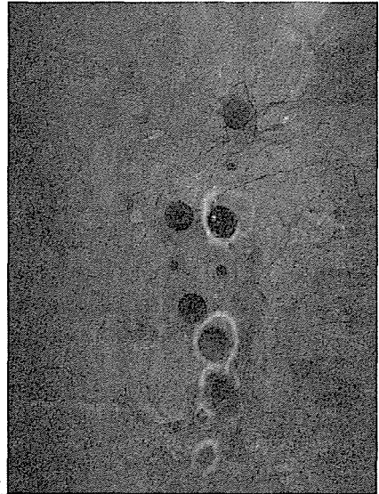
Resim 5. Rod kırılması ve deliklerin birleşmesi sonucu göbek deliklerinin bozulması
