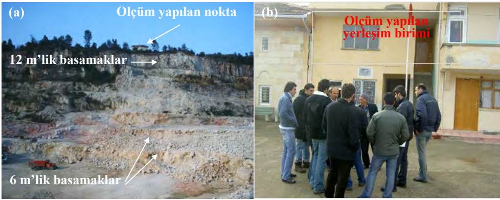
Şekil 2. Patlatma yapılan basamaklar ve titreşim ölçümü alınan yerleşim birimi
