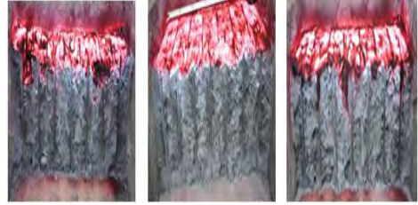
Şekil 2. Sıralı patlatmalardan sonra ES1 Alfa bloğu durumları
