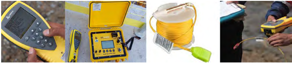
Şekil 1. (Sırasıyla) Tarayıcı (Scanner 200), Ateşleme kutusu (Blast Box R310), Elektronik kapsül (Unitronic 600) ve Scanner 200 ile tarama işlemi
