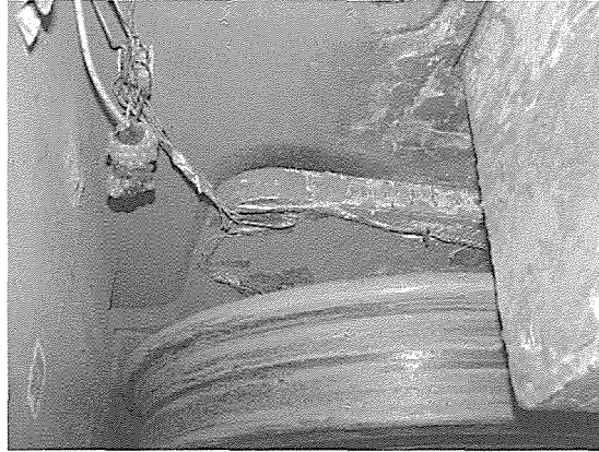
Şekil 3. İç şasi üzerine yapıştırılan gerinim-ölçerlerin üstten görünüşü.
