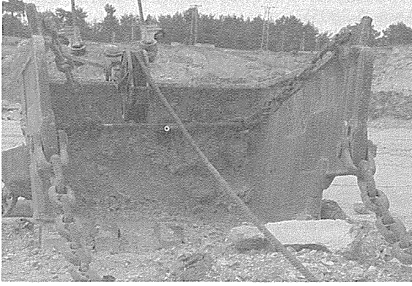
Şekil 2. 25 m 3 kapasiteli kemersiz bir kepçe ve koşum donanımı.
